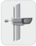
Tornillo de frenado, frena mediante un lado si se produce un resbalón involuntario o si se suelta el estribo corredizo. Se puede ajustar mediante el tornillo prisionero.
