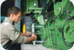
1 El tensor rápido garantiza un ajuste y reajuste rápido y sencillo.
